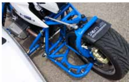
Stand der Technik: Die Achsschenkel lenkung der neuesten Generation.
